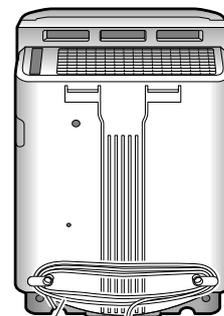
È possibile regolare la lunghezza del cavo di alimentazione arrotolando la parte in eccesso.
